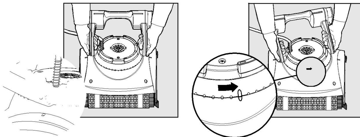
Нажмите кнопки на каждом поплавке и вытяните поплавки, удерживая кнопки нажатыми.
