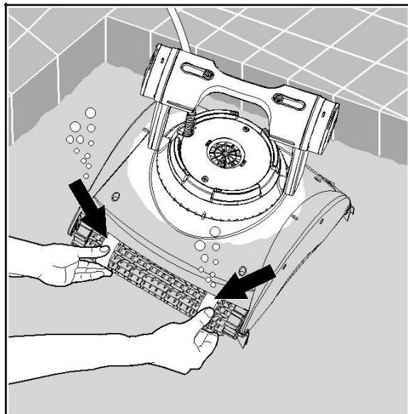
Если Ваш робот поставляется со щетками, которые включают в себя губки, погрузите щетки в воду и выжмите их, чтобы они полностью намокли перед первым использованием или если щетки высохли в перерыве между использованиями.
