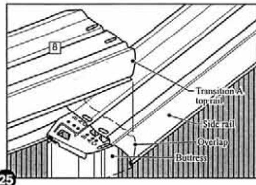
в. На конце бокового поручня расположенного **сверху** переходного поручня отметьте две длины  $\frac{1}{2}$ " (13 мм) и  $1\frac{1}{8}$ " (29 мм) от края конца поручня. Затем
