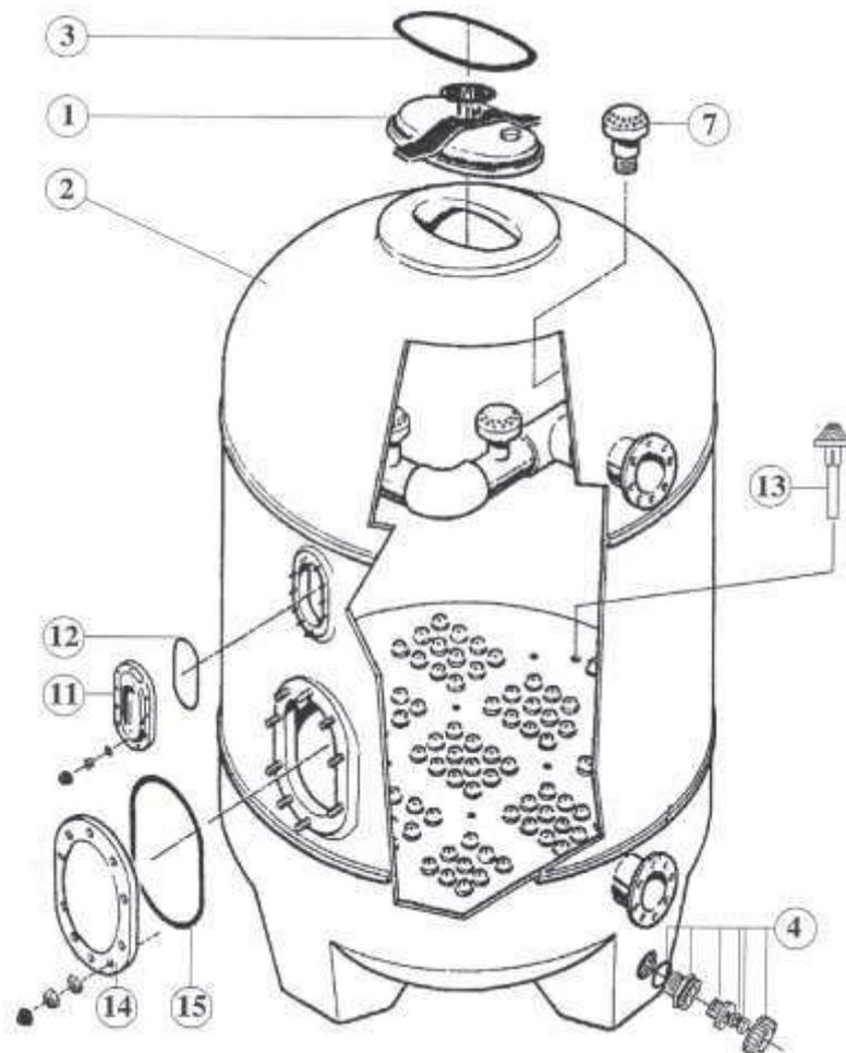
Детализровка «Позиции 2 Таблицы 2» (Обвязки фильтра Kripsol VKS 90-90.B) изображена на рисунке 4.
