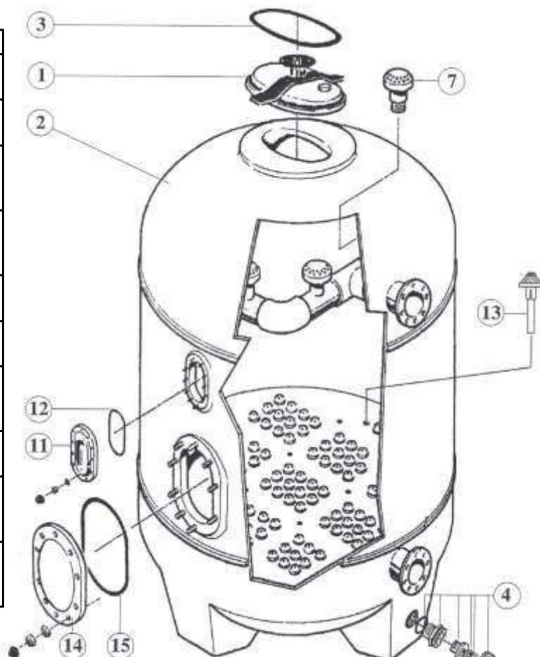
Детализовка «Позиции 2 Таблицы 2» (Обвязки фильтра Kripsol BKS 110-110.B) изображена на рисунке 4.
